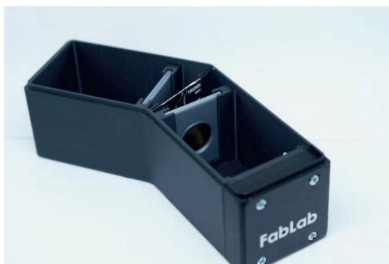
**Slika 4.1** 3D printani sklop spektrometra
